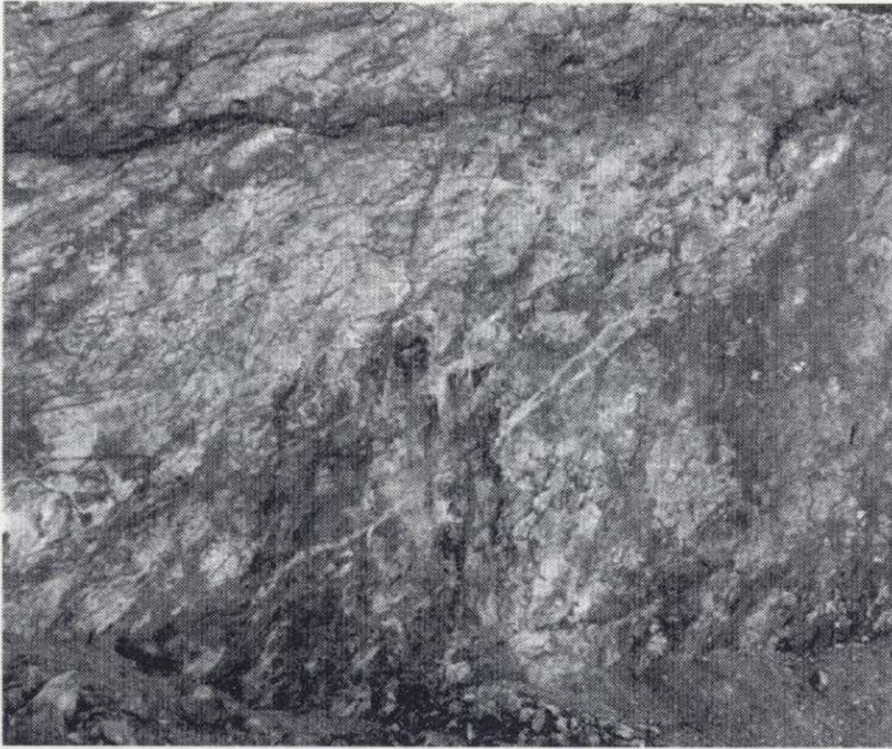
Foto 1. Venas ramificadas (branching veins) en el Banco 2 de la Parrilla. Se aprecian dos conjuntos filonianos principales que intersectan a fuerte ángulo. Orientación de la foto SE-NO (Altura del Banco 3.5 m).
