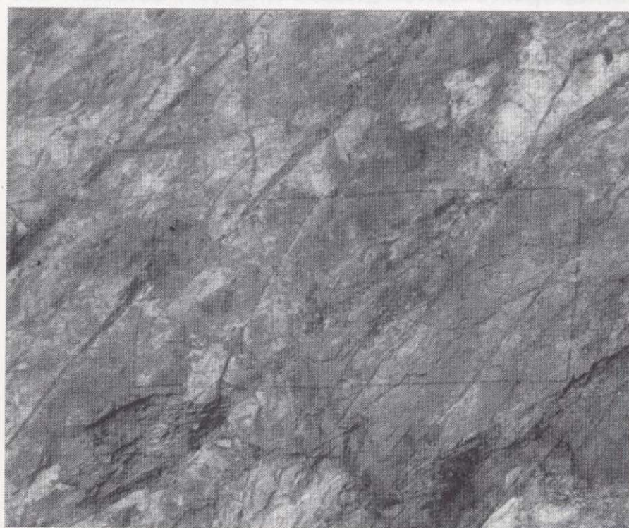
Foto 4. Filones y fracturas en un área seleccionada aleatoriamente, marco de dimensiones 1.87 x 0.85m, según un plano de dirección N105°E buzando 76°N, que es representativa de la geometría de la red de fracturas. Pared del Banco 2, La Parrilla.
